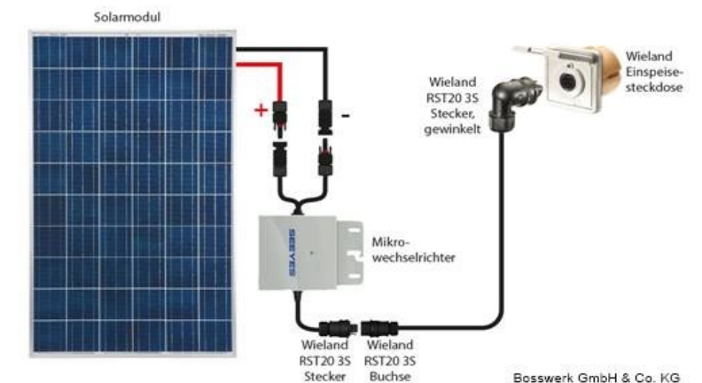
Aufbau einer Balkonkraftanlage
